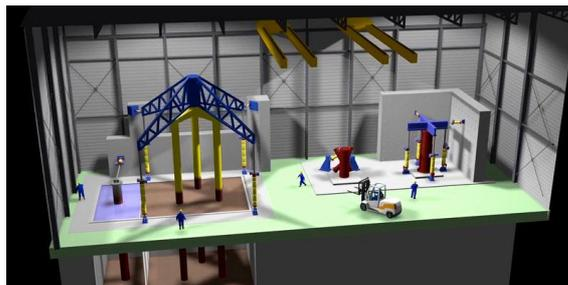
Bild 6: Prüfhalle mit Grundbauversuchsgrube und mehraxialem Spannfeld im TTH
