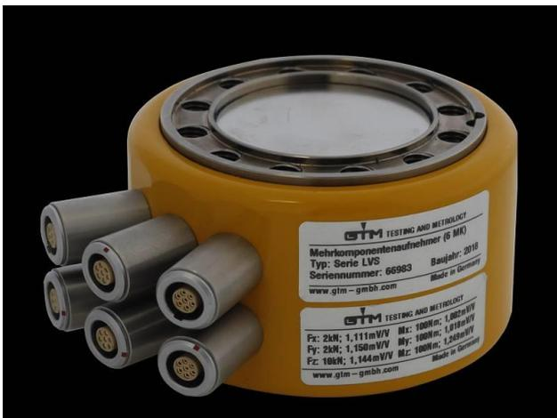
Datei 3: GTM Mehrkomponentenaufnehmer der Serie MKA
