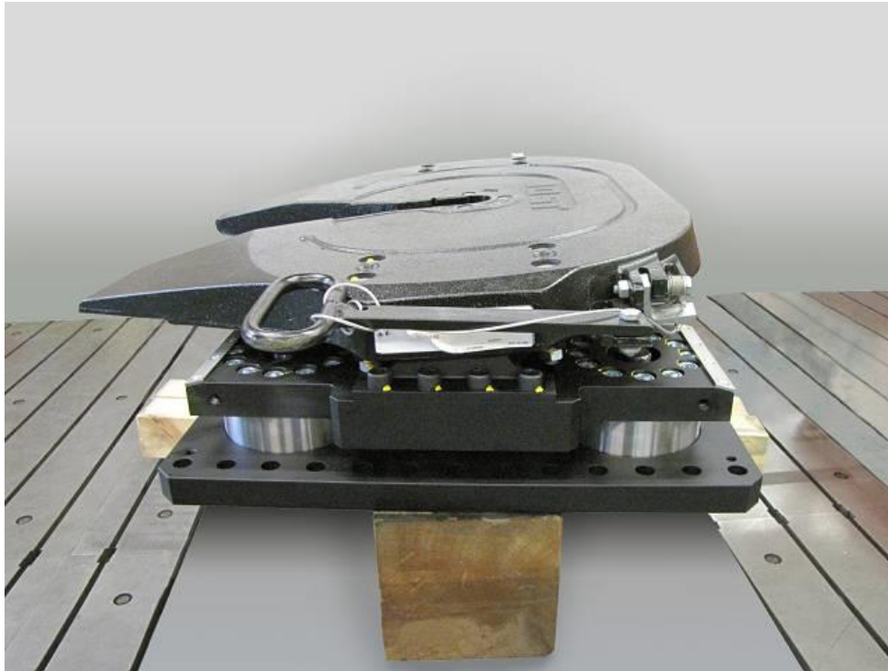
Bild 1: Messsattelkupplung im Labor
