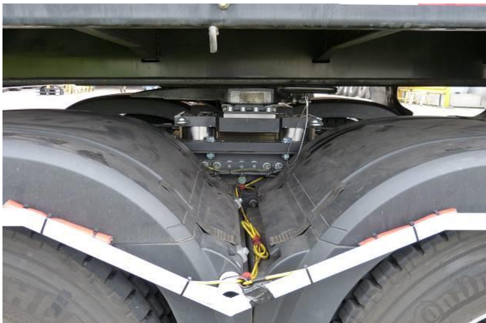
Bild 2: Messsattelkupplung im Einsatz
